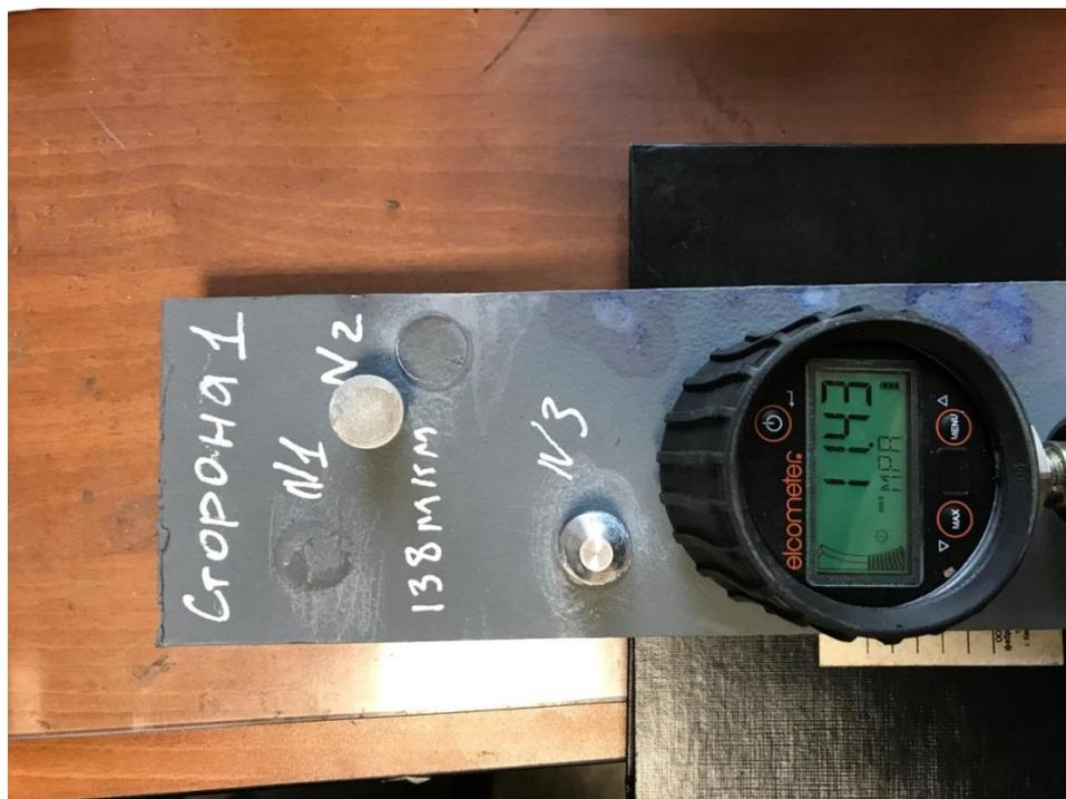
ОТЧЕТ ПО ИЗМЕРЕНИЮ АДГЕЗИОННОЙ ПРОЧНОСТИ ПОКРЫТИЯ ПО ИСО 16276-1
