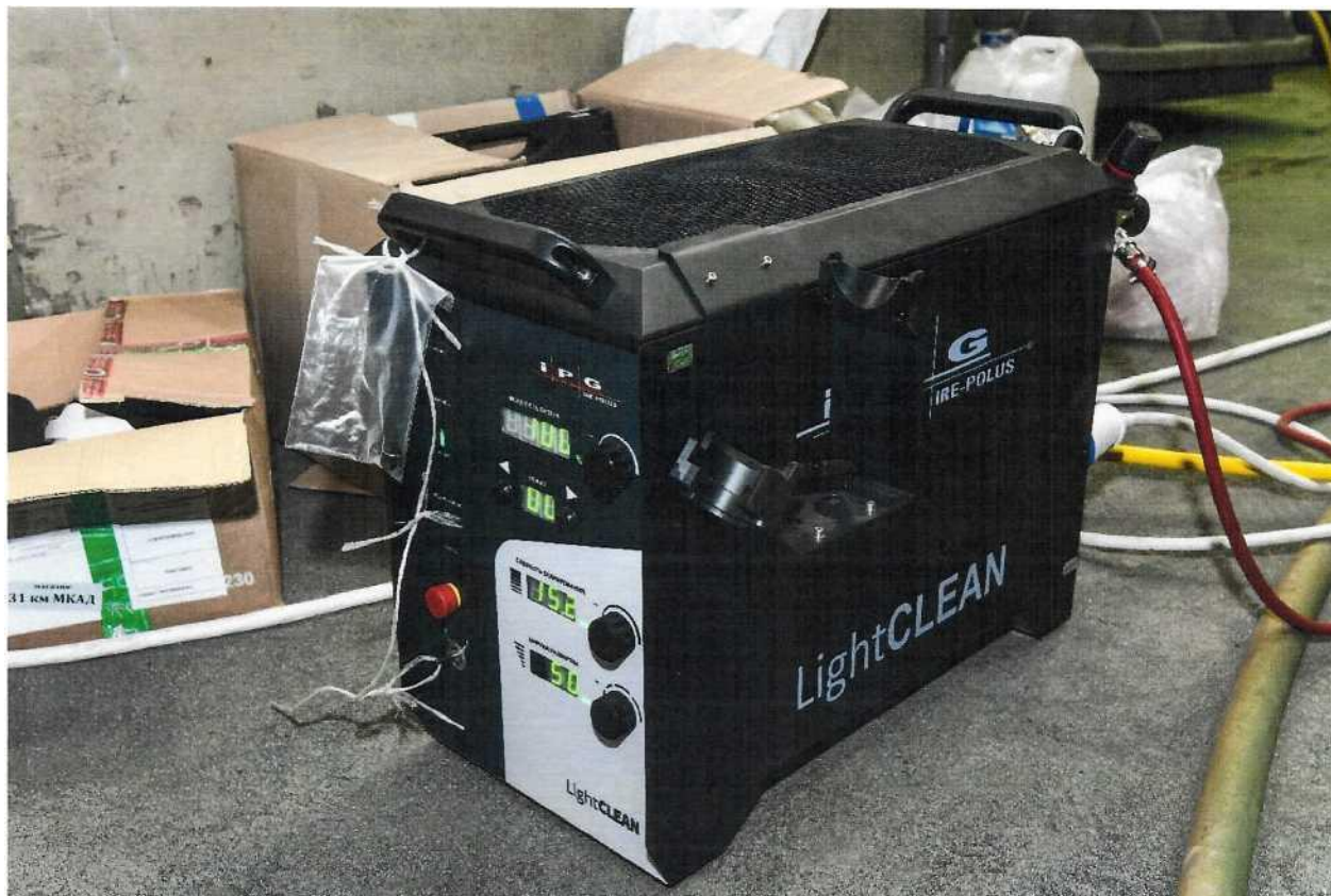
Фото 1. Внешний вид демонстрируемого аппарата лазерной очистки.
