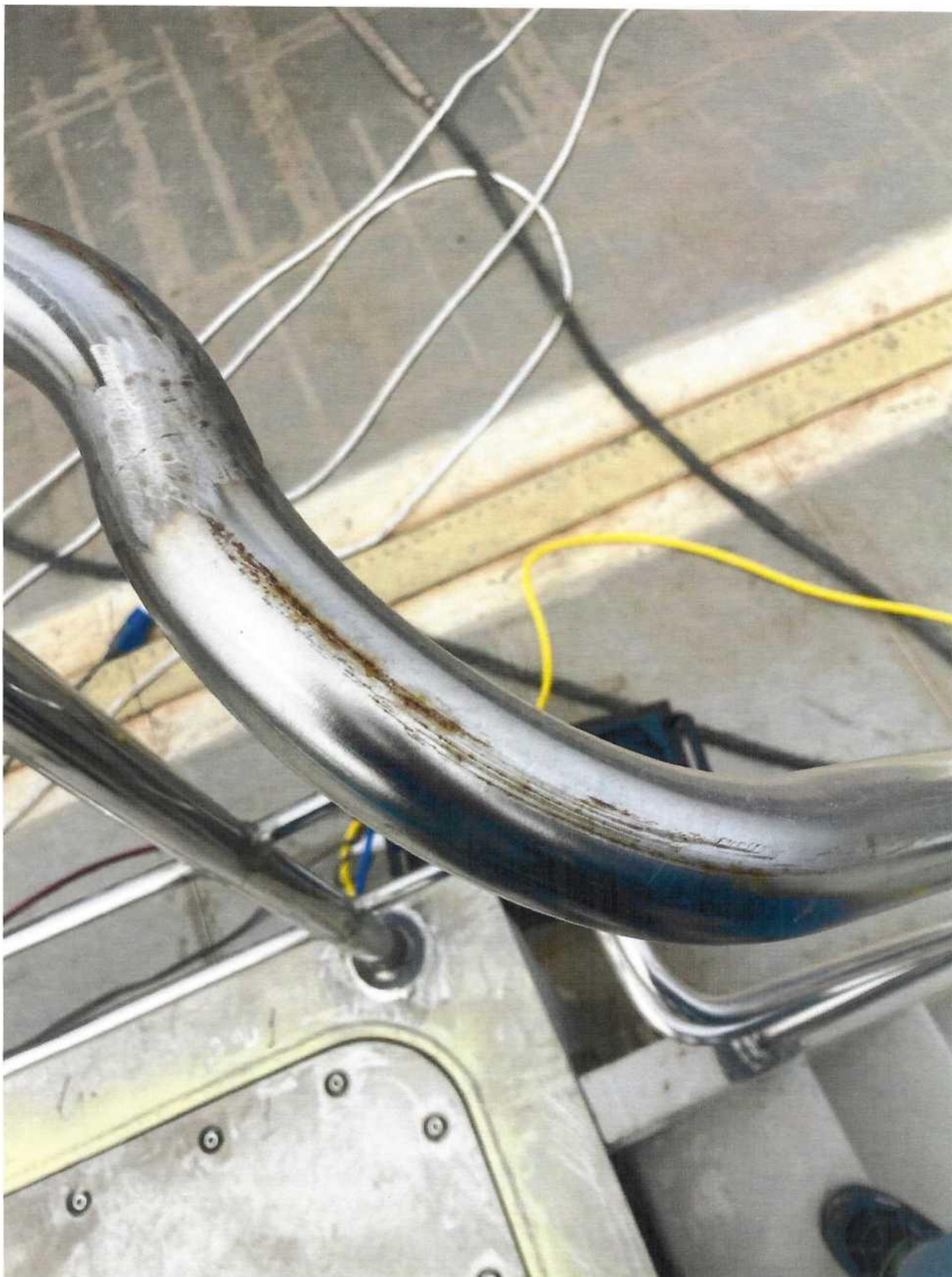
Фото 17. Исходный образец трубы леерного ограждения, поражённого ржавчиной. Материал - нержавеющая сталь.
