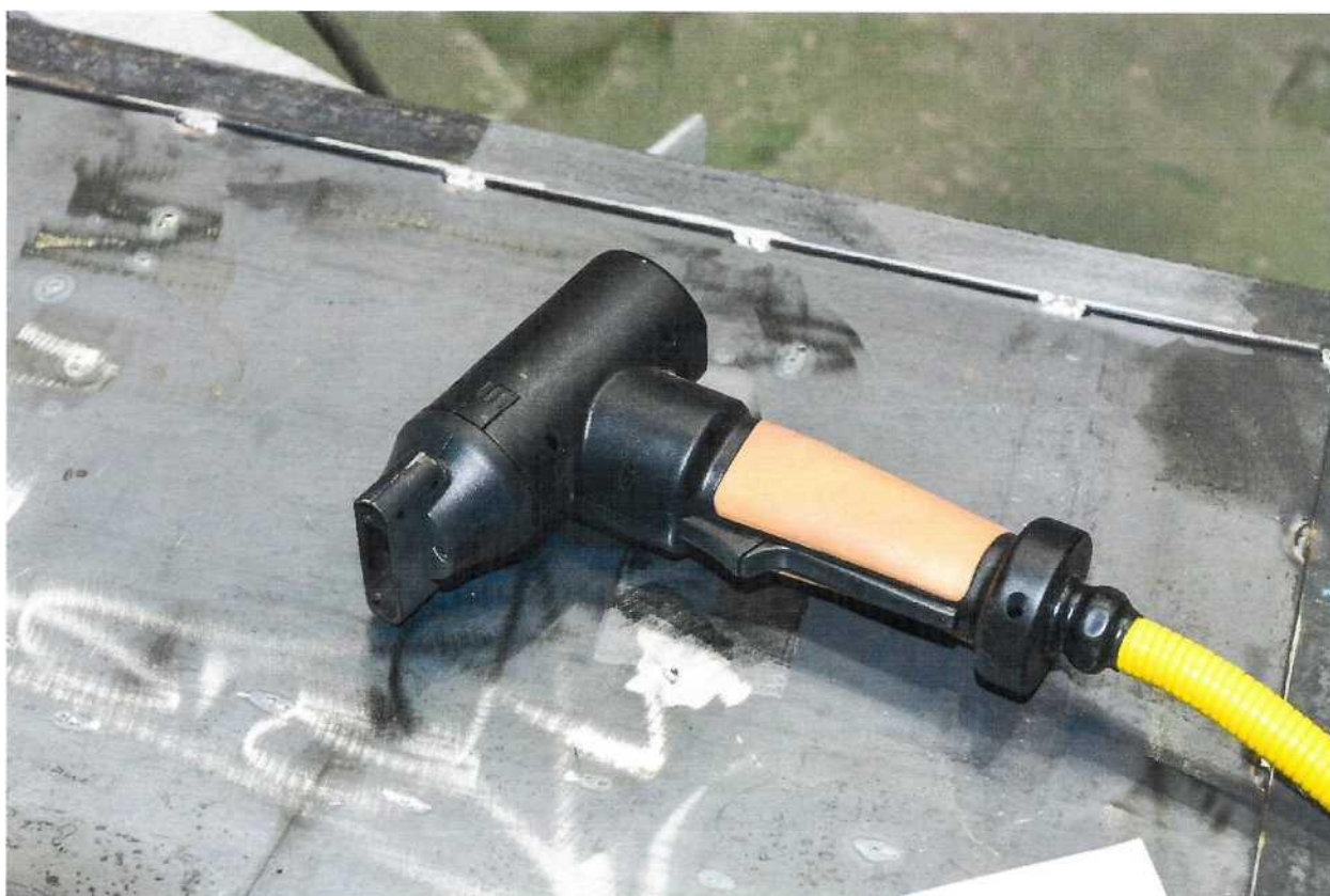
Фото 3. Исполнительный орган (пистолет) демонстрируемого аппарата лазерной очистки.
