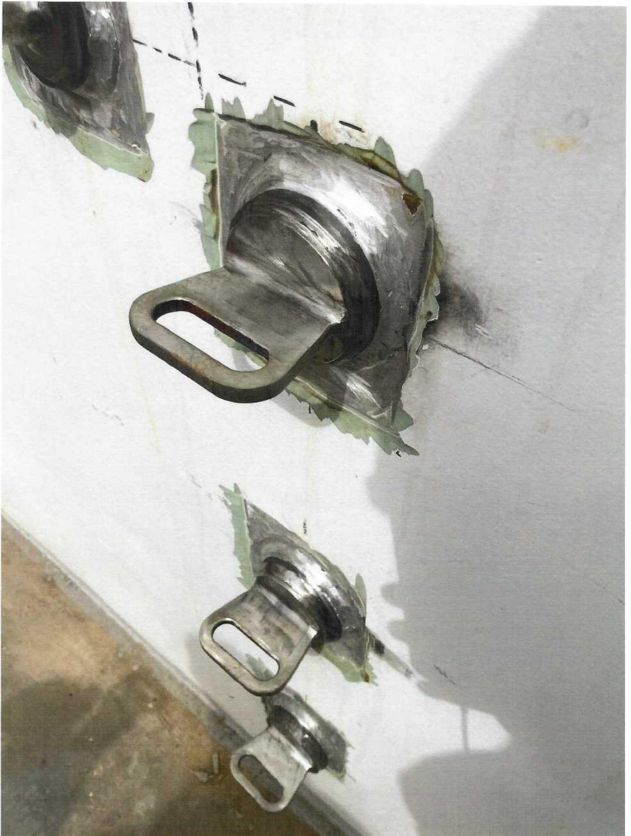
Фото 20. Образцы биметаллических пластин крепления леерных ограждений после операции лазерной очистки. Загрязнение - ржавчина.
