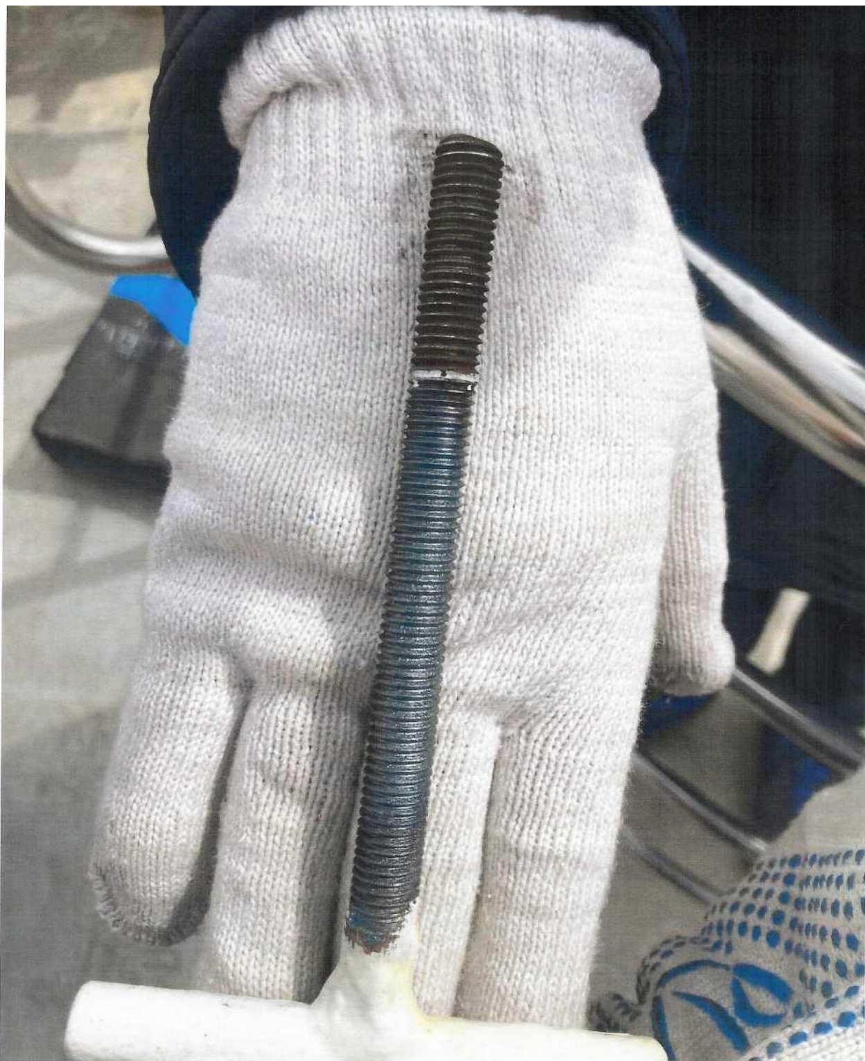
Фото 15. Результат очистки резьбы от загрязнения ржавчиной.
