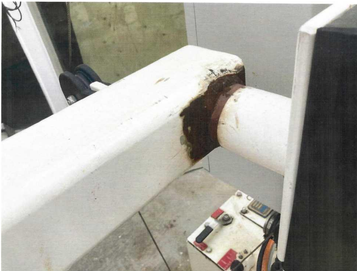
Фото 12. Исходный вариант загрязнения сварного шва. Материал Ст3. Вид загрязнения - ржавчина и двухкомпонентный эпоксидный ЛКМ.
