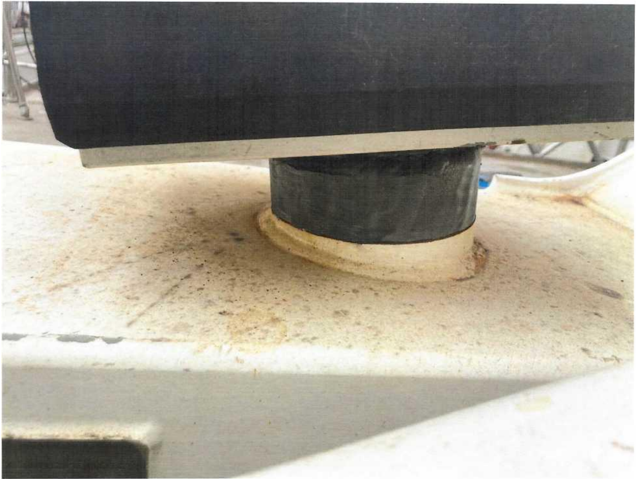
Фото 11. Окончательный вариант после обработки. Деталь - опора дежурной шлюпки. Материал Ст3. Тип удалённого загрязнения - ржавчина, в том числе в районе сварного шва.
