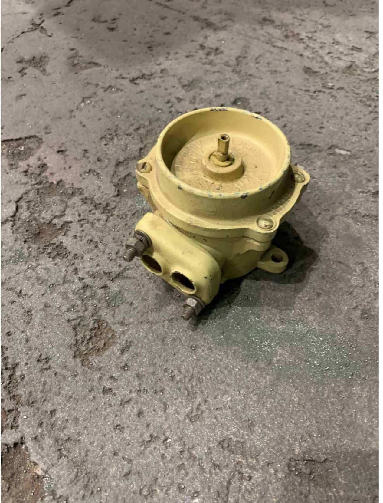
Фото 32. Исходное состояние образца - Судовой выключатель. Материал алюминий. Обрабатываемая поверхность - ЛКП ПФ-218 в 2 слоя 100 мкм.
