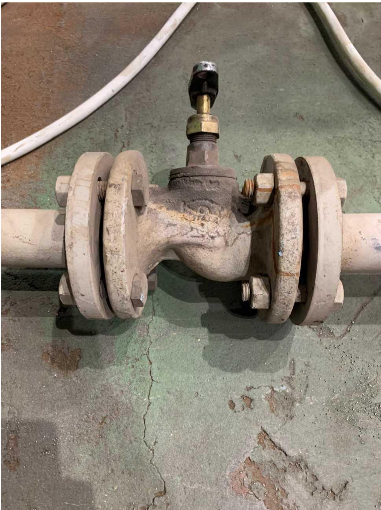
Фото 30. Исходное состояние образца - Кран Ду50. Материал чугун. Обрабатываемая поверхность - ЛКП ПФ-218 в 1 слой 50-60 мкм.
