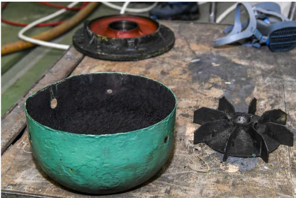
Фото 26. Исходные образцы. Крыльчатка охлаждения электродвигателя. Материал алюминий. Обрабатываемая поверхность - масляные загрязнения. Крышка электродвигателя с посадочным местом под подшипник, окрашенной ФЛ-03К в 1 слой. Обрабатываемая поверхность - масляные загрязнения.
