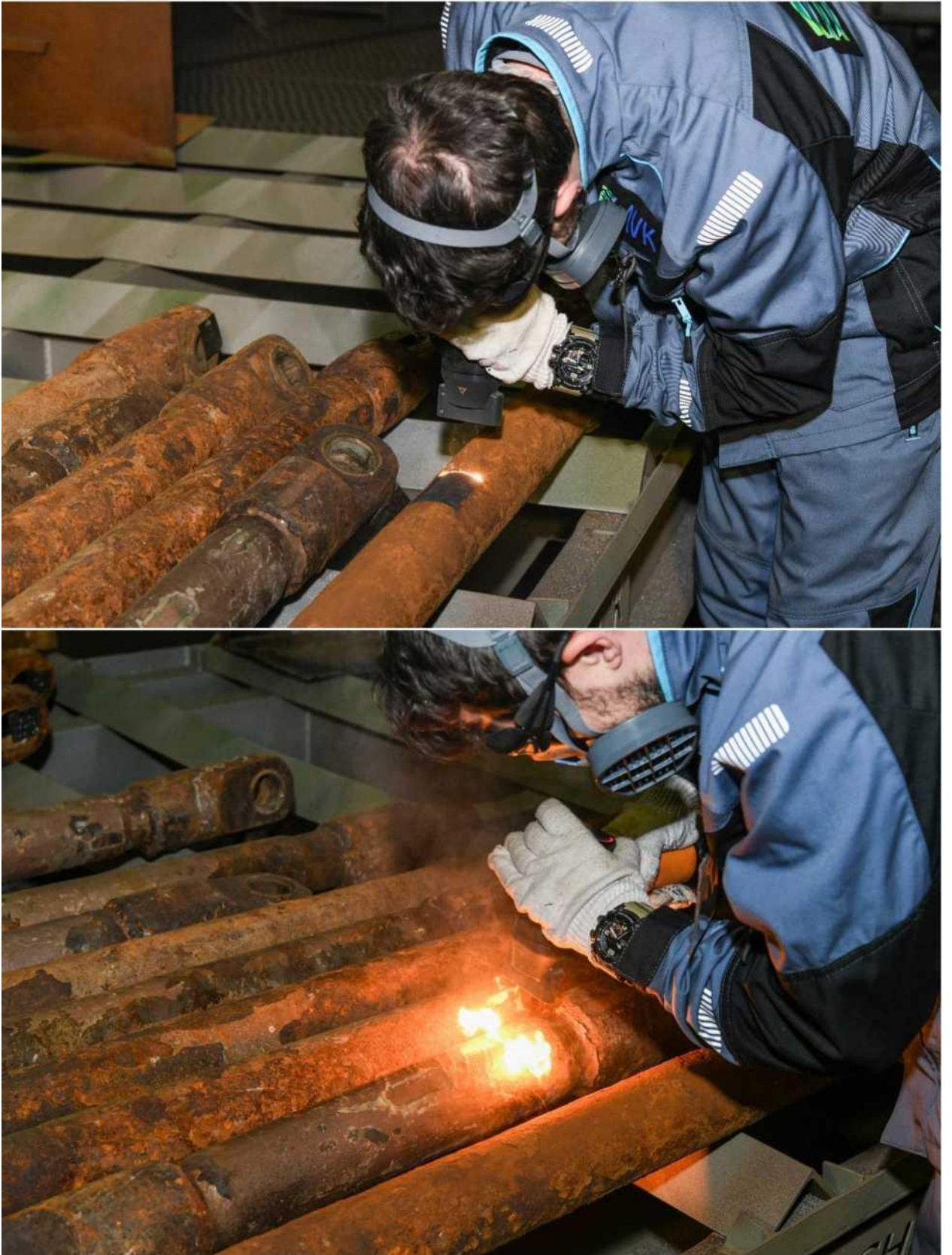
Фото 12. Сотрудник АО «АВК» осуществляет процесс очистки образцов - Тяга привода.
