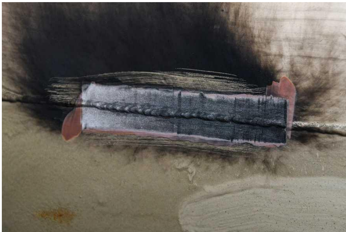
Фото 18. Результат обработки образца - Стенд для проведения опытных работ. Материал СТЗ. Обрабатываемая поверхность: сторона № 1 - покрытие ЛКП типа Interschild толщиной 250-300 мкм. Обработка прямого сварного
