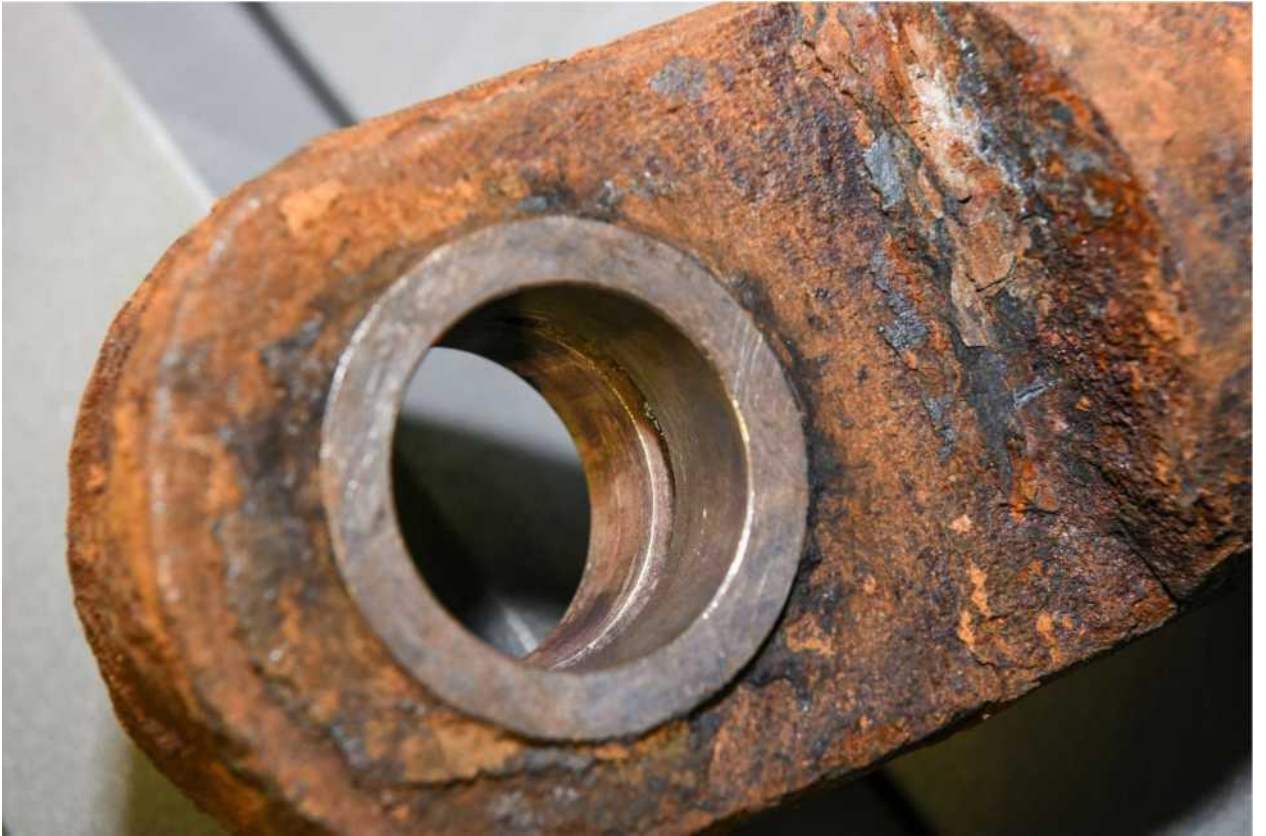
Фото 15. Результат очистки образца - Тяга привода. Обработываемая поверхность - латунная втулка.
