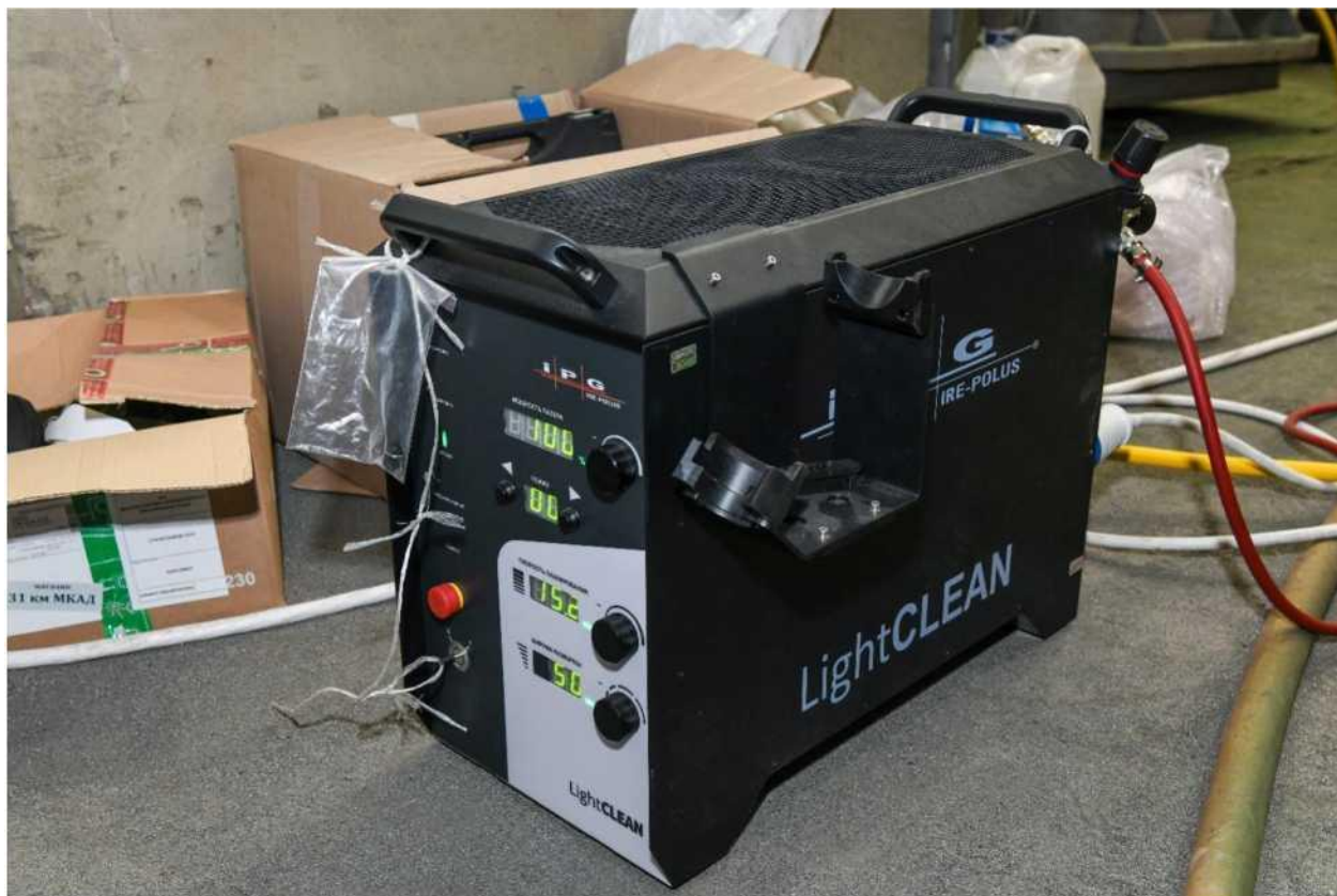
Фото 1. Внешний вид демонстрируемого аппарата лазерной очистки.
