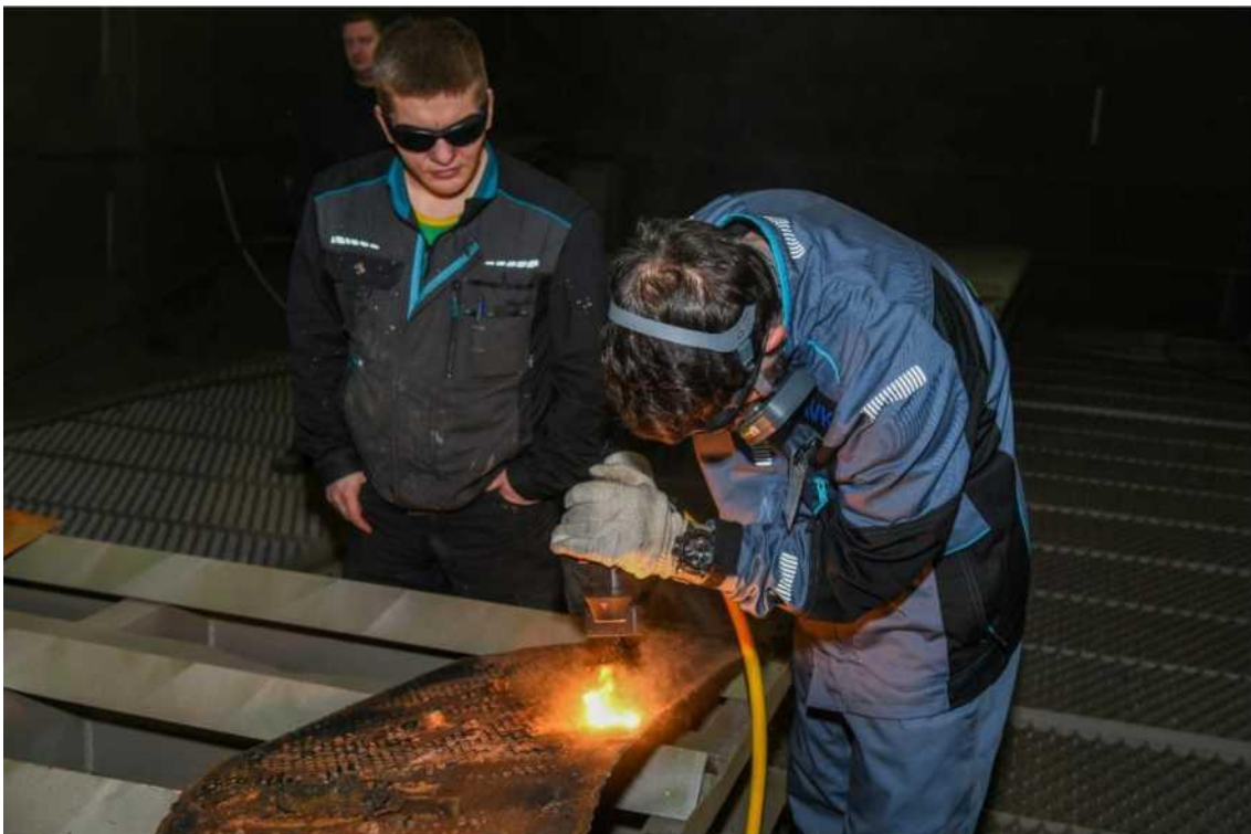
Фото 8. Сотрудник АО «АВК» осуществляет процесс очистки образца - Секция надстройки. Обрабатываемая поверхность - остатки спецпокрытия и ЛКП типа ЭП-0010 толщиной до 2500 мкм.
