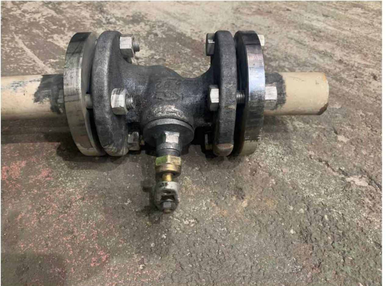
Фото 31. Результат апробации технологии лазерной очистки на изделии Кран Ду50. Материал чугун. Обрабатываемая поверхность - ЛКП ПФ-218 в 1 слой 50-60 мкм.
