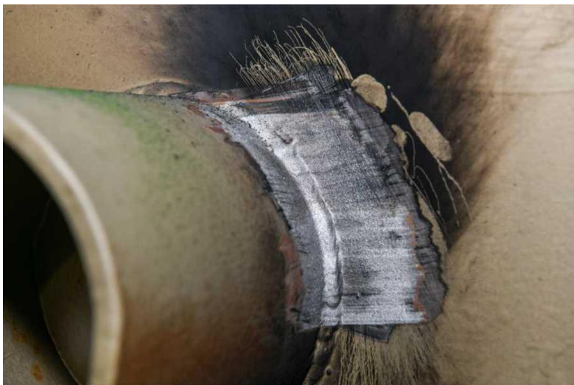
Фото 18. Результат обработки образца - Стенд для проведения опытных работ. Материал СТЗ. Обрабатываемая поверхность: сторона № 1 - покрытие ЛКП типа Interschild толщиной 250-300 мкм. Обработка прямого сварного
