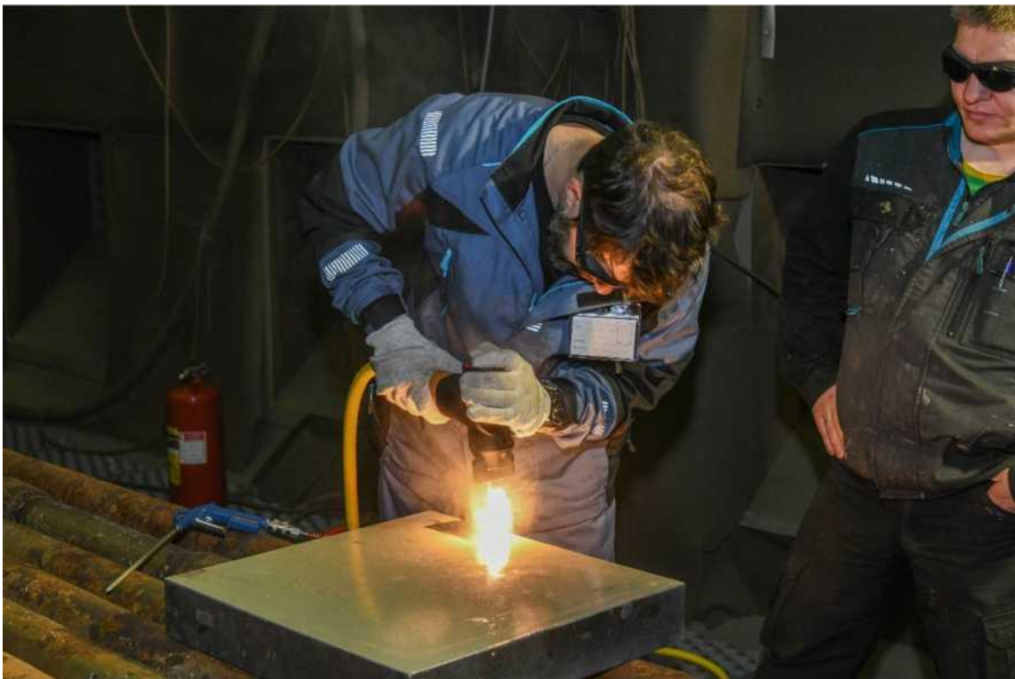
Фото 5. Сотрудник АО «АВК» осуществляет процесс очистки образца резины ПЛ-78 размером 0,25 \text{ м}^2 , окрашенного ПФ-115 в 1 слой.
