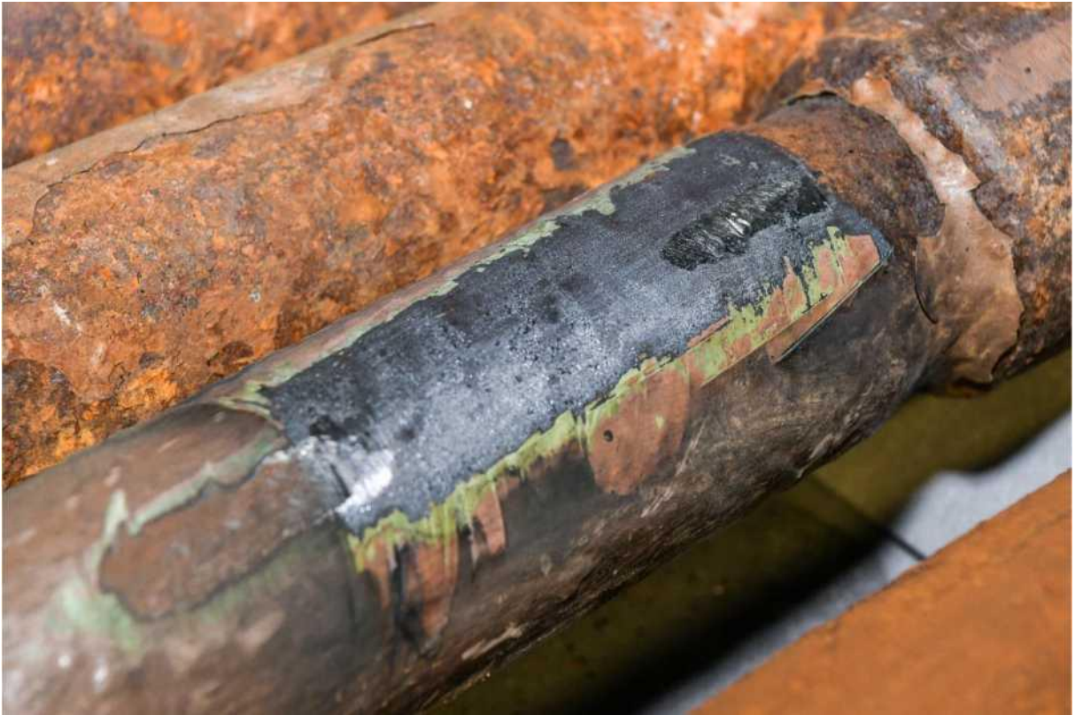
Фото 13. Результат очистки образца - Тяга привода. Обрабатываемая поверхность - толстостенное ЛКП типа БЭП.
