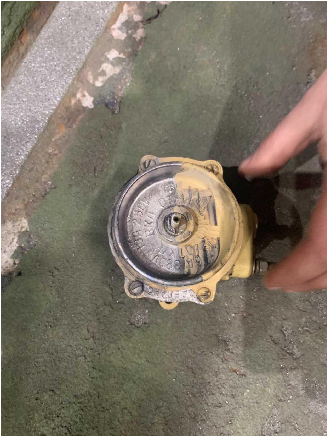
Фото 33. Результат апробации технологии лазерной очистки на изделии - Судовой выключатель. Материал алюминий. Обрабатываемая поверхность - ЛКП ПФ-218 в 2 слоя 100 мкм. Видно, что в результате обработки вся маркировка идеально сохраняется.
