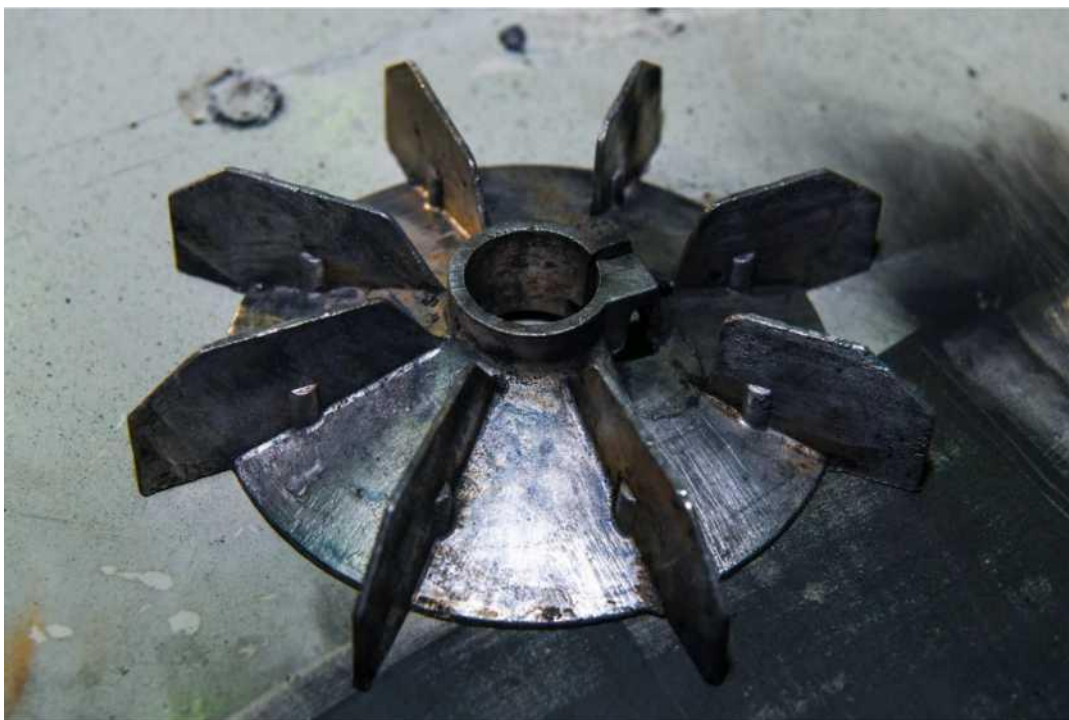
Фото 27. Результат очистки крыльчатки охлаждения электродвигателя. Материал алюминий. Обрабатываемая поверхность - масляные загрязнения.
