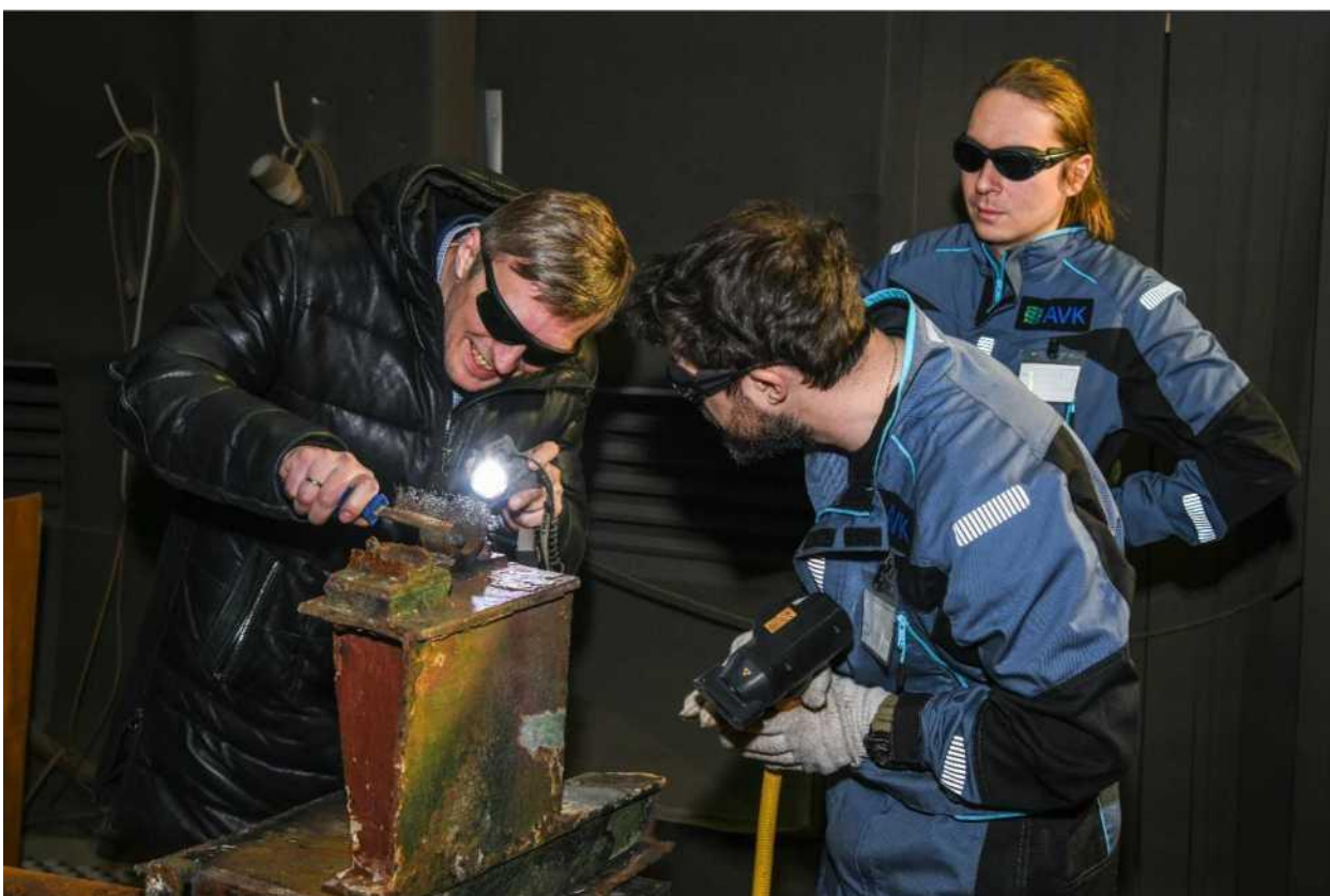
Фото 24. Сотрудники АО «АВК» оценивают результат обработки Исходный образец - металлоконструкция. Материал СТЗ. Обрабатываемая поверхность - язвенная коррозия.
