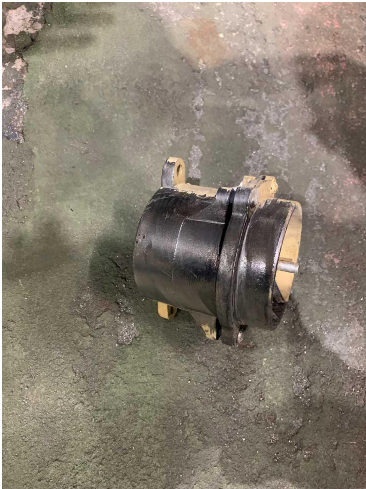
Фото 34. Результат апробации технологии лазерной очистки на боковой поверхности изделия - Судовой выключатель. Материал алюминий. Обрабатываемая поверхность - ЛКП ПФ-218 в 2 слоя 100 мкм.
