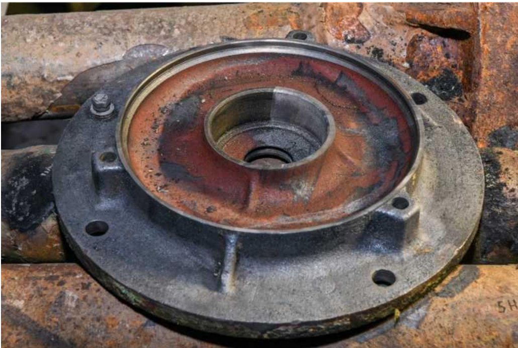
Фото 29. Результат очистки крышки электродвигателя с посадочным местом под подшипник, окрашенным ФЛ-03К в 1 слой. Обрабатываемая поверхность - масляные загрязнения.
