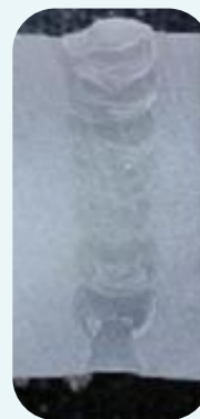
Поперечный и продольный макрошлиф сварного соединения пластин толщиной 24 мм
