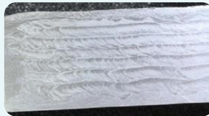
Поперечный и продольный макрошлиф сварного соединения пластин толщиной 24 мм
