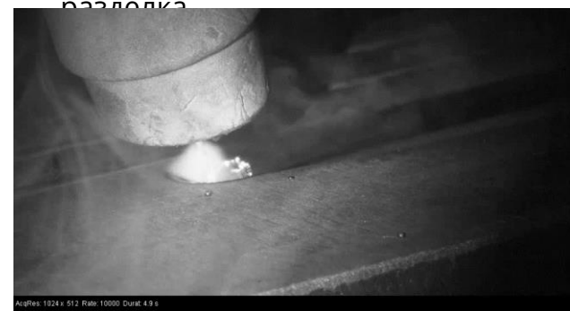
Процесс сварки 16 мм V_{св} = 1,0 м/мин, P = 10 кВт
